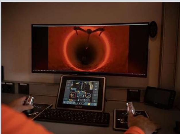
Rovion-Inspektionssystem bei der Deformationsvermessung
