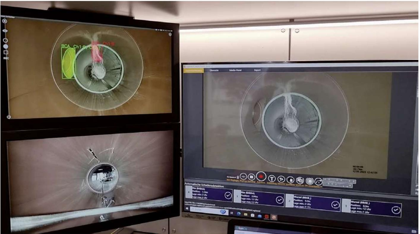
Sarida Edge – KI-basiertes Assistenzsystem für den Operator während der TV-Inspektion | Foto: e.SIC
